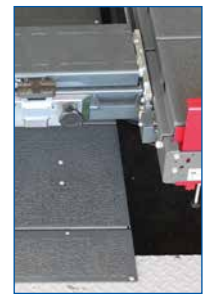
DUO CM im Rechteckfundament mit (optionaler) Gitterberostung (Ausstattung für Fahrzeugprüfung).
