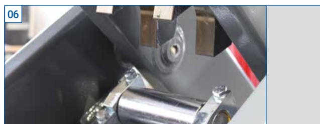
Die Zylinder-Aushubunterstützung mit Stufenhebel und Rollen führt eine reine Abrollbewegung aus. Keine Gleitbe- wegung zwischen den bewegten Teilen, dadurch geräusch- los, verschleiß- und wartungsarm.
