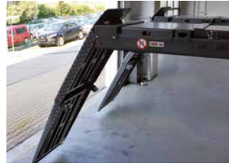
Klapp-Auffahrrampe bei hohen Fahrflächen oder geringem Auffahrwinkel
