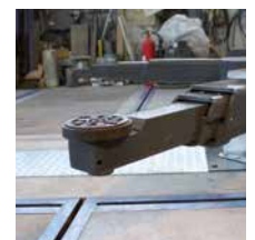
Unterschwenkhöhe am Aufnahmeteller von 101 mm
