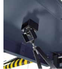
Befestigungssystem und Arretierung der Fahrflächenabstützung.
