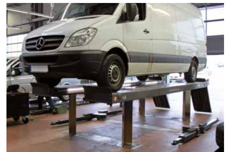
Große Bewegungsfreiheit unter der Fahrfläche bei hoher Stabilität
