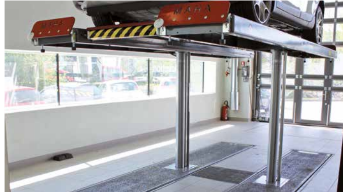
Fahrzeug an den Rädern gehoben
