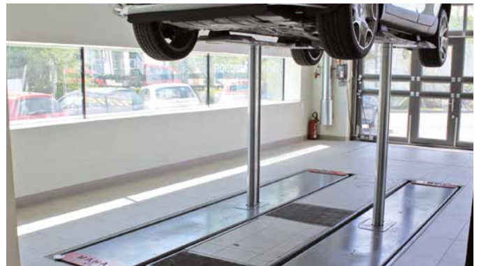
Fahrzeug am Schweller gehoben
