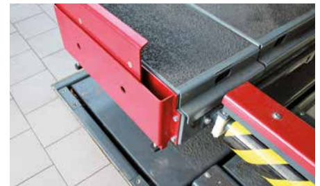
Der Bodenausgleich unter der Fahrfläche ist ein zweiter Boden, der die Fläche unter der Hebebühne wieder ebnet.
