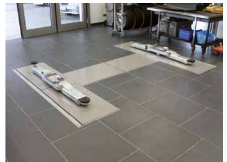
Die Hebebühne kann mit geschlossener Abdeckung als Standardhebebühne genutzt werden
