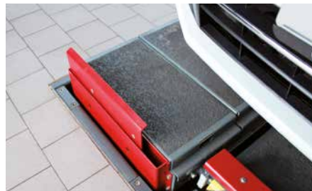
Der Bodenausgleich unter der Fahrfläche ist ein zweiter Boden, der die Fläche unter der Hebebühne wieder ebnet.
