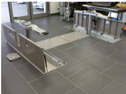
Rahmensystem mit Abdeckplatten, komplett feuerverzinkt
