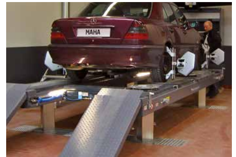
Hohe Genauigkeit als Achsmessehebühne
