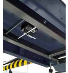
Befestigungssystem und Arretierung der Fahrflächenabstützung.
